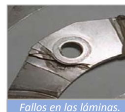
Las marcas de acoplamientos de Altra, han desarrollado Tri-Bushing™, un elemento flexible único (lámina) con un diseño de casquillo triangular que incrementa la capacidad axial de los acoplamientos flexibles de láminas de alto rendimiento en aplicaciones de turbo-maquinaria.
