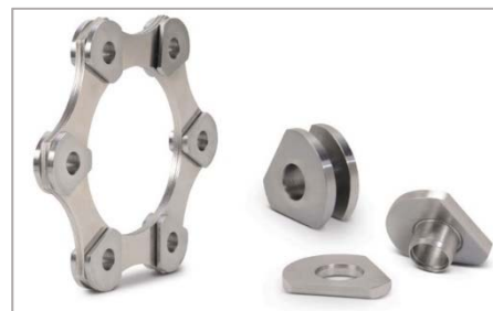
Las marcas de acoplamientos de Altra, han desarrollado Tri-Bushing™, un elemento flexible único (lámina) con un diseño de casquillo triangular que incrementa la capacidad axial de los acoplamientos flexibles de láminas de alto rendimiento en aplicaciones de turbo-maquinaria.
