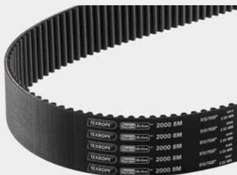
Las correas síncronas de caucho TEXROPE® SupraDrive™ destacan por proporcionar un funcionamiento continuo y fiable en transmisiones de rendimiento estándar. Su perfil de dientes curvilíneo con un revestimiento del dentado resistente al desgaste y la capacidad de carga dinámica de sus cuerdas de tracción altamente resistentes garantizan una durabilidad, un rendimiento y una eficiencia excelentes.
